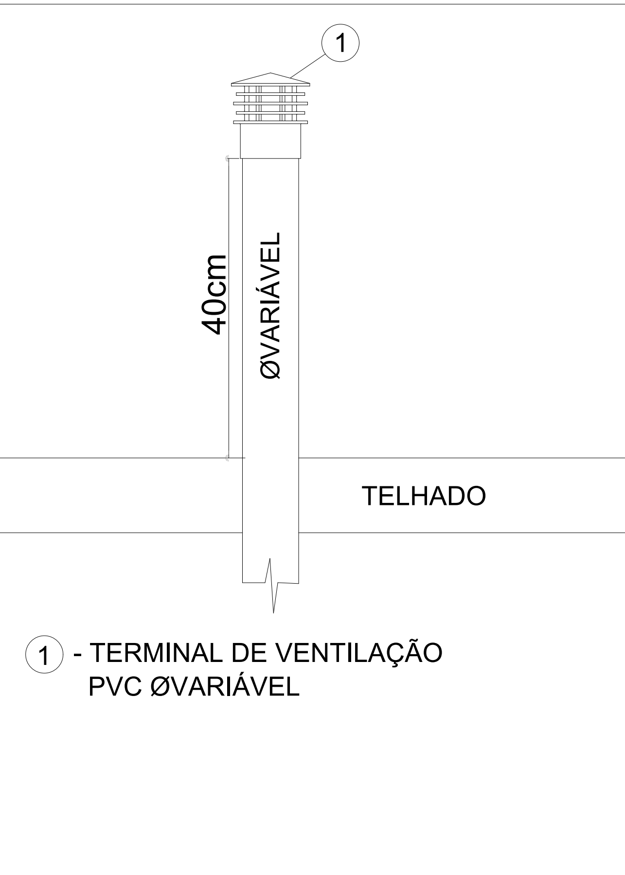
DETALHE GENÉRICO DOS TERMINAIS DE VENTILAÇÃO PVC ØVARIÁVEL SEM ESCALA
